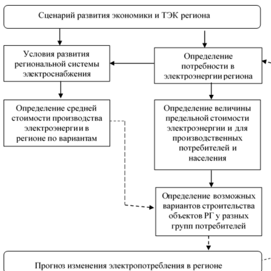
Рис. 1. Принципиальная схема предлагаемого подхода для оценки влияния масштабов распределенной генерации на электропотребление в регионе
