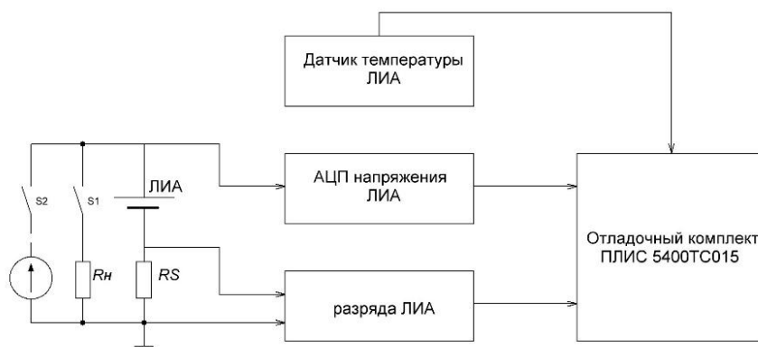
Рис.1. Принципиальная схема стенда для работы с отладочным комплектом ПЛИС
