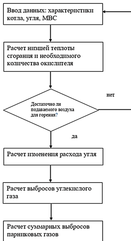
Рис. 1. Блок-схема для расчета суммарных выбросов парниковых газов
