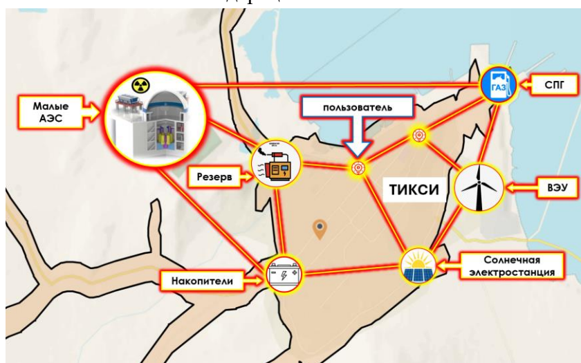
Рис. 1. Эскиз схемы энергоснабжения на примере пос. Тикси
